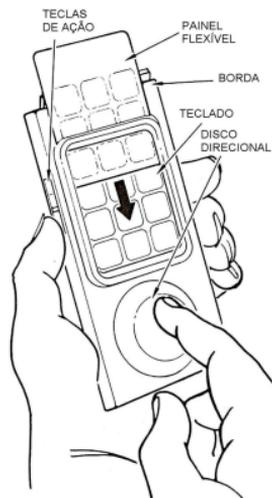
Introduza os painéis flexíveis do "D2K" dentro dos controles, cobrindo os respectivos teclados. Insira o cartucho no console (consulte o manual de instruções para maiores detalhes sobre as conexões).
